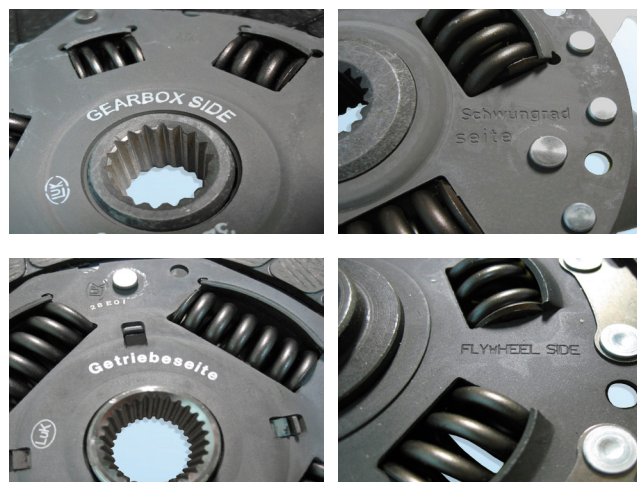
Obrázek 1-4: Možné popisy na spojkové lamele
