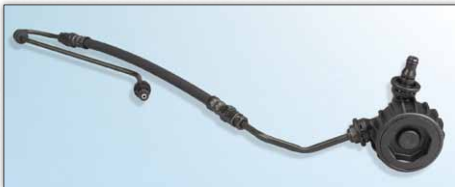
Slika 1: Hidravlični vod s frekvenčnim modulatorjem (protivibracijska enota)
