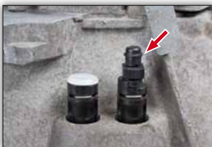
Slika 8: Čepček za odzračevanje lahko aktivirate z roko ali z zevnim ključem (SW 13)
