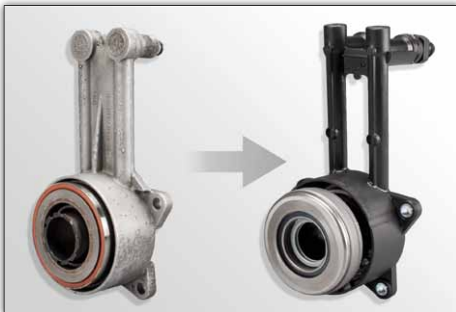
Slika 1: Kovinsko izvedbo artikla je zamenjala plastična izvedba
