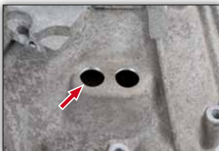
Slika 6: Posneti robovi in očiščen zvon menjalnika
