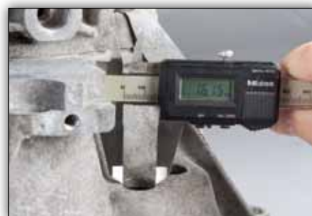
Slika 2: Če je premer lukenj manjši od 21mm, jo je treba navrtati do najmanj 21mm, največ 24mm
