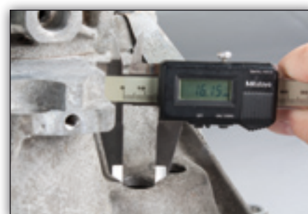
Fig. 2: Als de diameter kleiner is dan 21 mm, moet worden uitgeboord naar min. 21 mm, max. 24 mm
