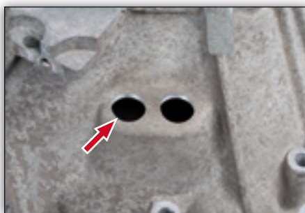
Fig. 6: Ontbramen en reinigen
