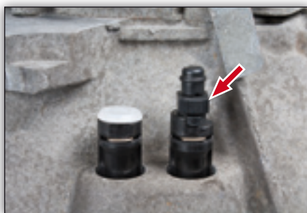
Fig. 8: De ontluichtingsnippel kan met de hand of met een steeksleutel (SW 13) in werking worden gesteld.
