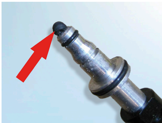
Figur 4: Dersom den gamle tetningen ikke er fjernet, kan den bli trykket inn i CSC og blokkere røret.
