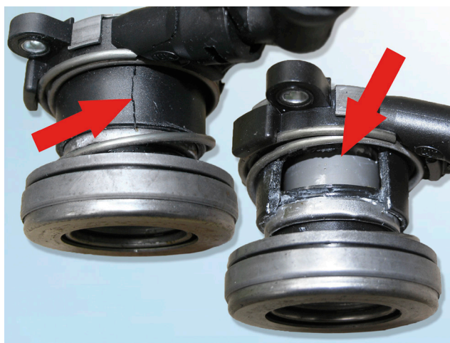
Billede 5: Central frigørelsesmekanisme ødelagt ved forkert montering
