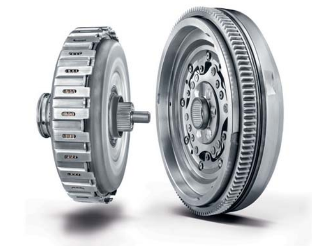
1 Double embrayage humide 2 Volant bimasse
