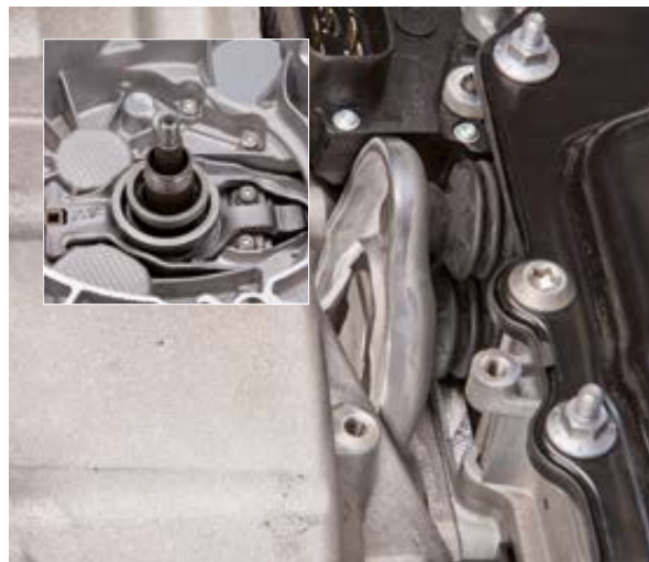
Μοχλός εμπλοκής από φύλλο χάλυβα – ημερομηνία κατασκευής κιβωτίου από Ιούνιο 2011, 2n γενιά
