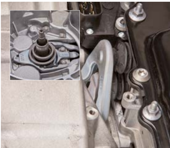
Χυτοσιδηρός μοχλός εμπλοκής – ημερομηνία κατασκευής κιβωτίου μέχρι Μάιο 2011, 1n γενιά
