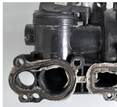
Fig. 5: Vazamentos devido a produtos de vedação adicionais (imagem do dano)
