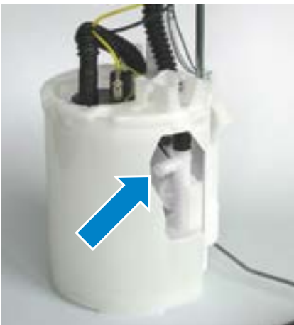
Fig. 1: Vista del modulo alimentazione carburante (profilo) con attacco cieco
