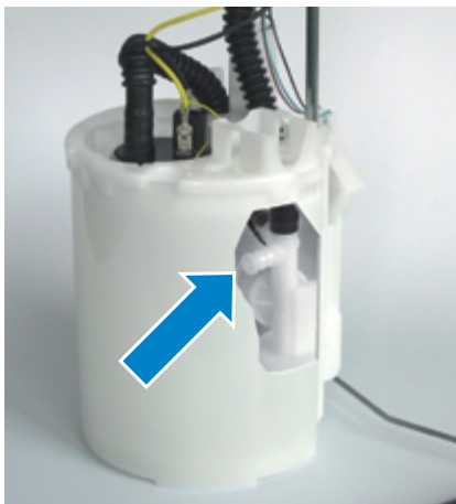
Fig. 1 : Vue dans le module d'alimentation en carburant (coupe verticale) avec bouchon
