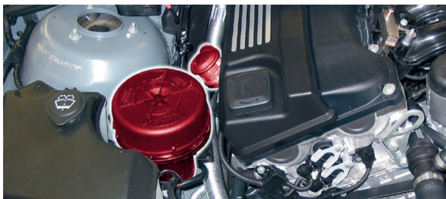
Valvola dell'aria secondaria e pompa dell'aria secondaria in BMW E46 (sottolineato)
