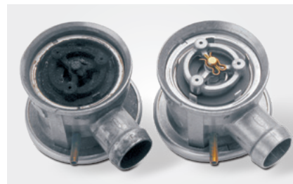
Valvola dell'aria secondaria aperta A sinistra: danni causati dalla condensa dei gas di scarico Lato destro: stato a nuovo
