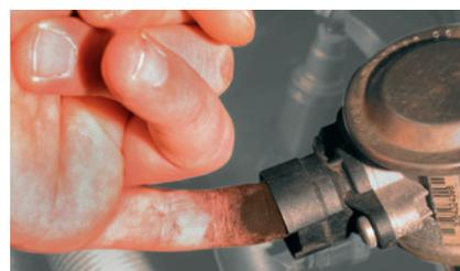
"Prueba dactilar" en la válvula de aire secundario en el BMW 520i (destacada)
