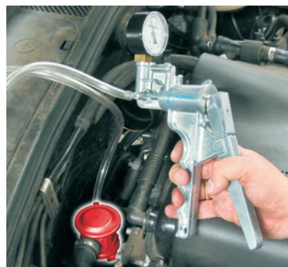
Comprobar una válvula de aire secundario con una bomba manual de depresión
