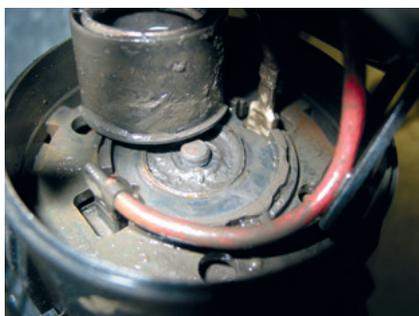
Condensado de gases de escape agresivo en el motor de accionamiento de una bomba de aire secundario
