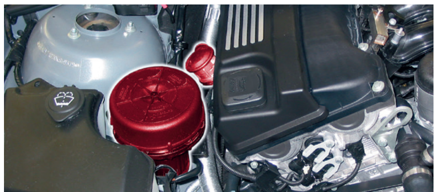
Ventil sekundárního vzduchu a čerpadlo sekundárního vzduchu ve vozidle BMW E46 (zvýrazněno)
