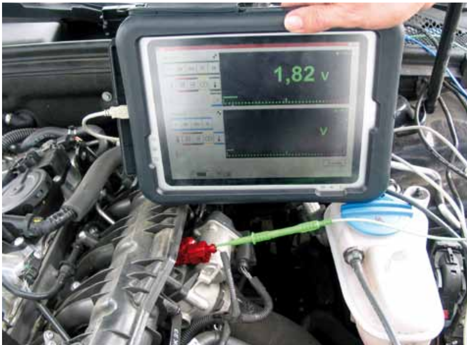
A kimeneti feszültség mérése egy szívócsőnyomás-érzékelőn (kiemelve) az Audi A4 TFSI-ben
