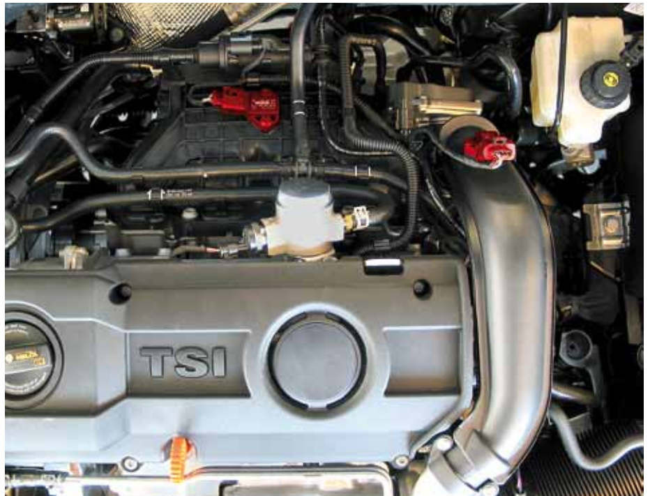
Szívócsőnyomás-érzékelő (balra) és töltőnyomás-érzékelő (jobbra) a VW Golf VI-ban (pirosra színezve)
