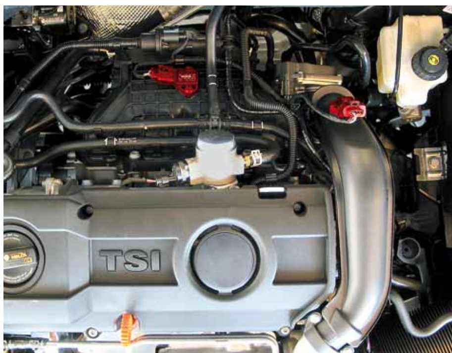
Sensor de presión del tubo de aspiración (izquierda) y sensor de presión de carga (derecha) en el VW Golf VI (resaltado en rojo)
