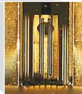
La sonda di misurazione di un sensore della massa d'aria sotto il microscopio.
