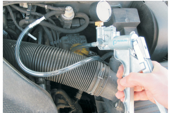
Contrôle d'une EPW avec la pompe à dépression manuelle (VW Golf IV) (Pierburg numéro d'article 12 00001 11 900)
