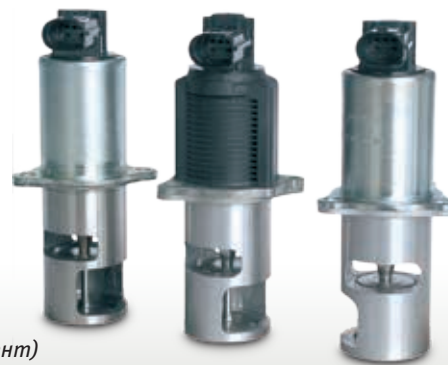
Залипший клапан системы EGR и новый клапан
