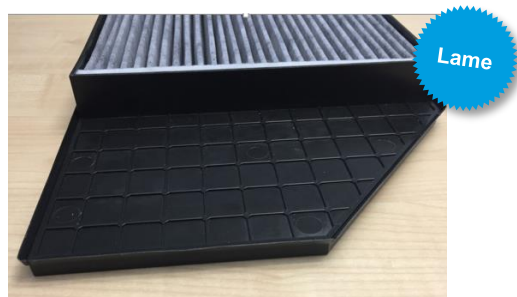
Image 1: La solution IAM est dotée d'une lame, de sorte qu'aucune broche ne pénètre. En outre, une image pliante nettement meilleure est produite en collant l'élément dans le cadre en plastique.
